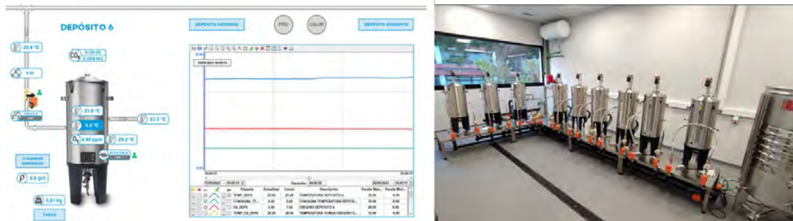
Figura 1: A la izquierda, imagen de la interfaz de control de un depósito. A la derecha, foto de la planta piloto.
